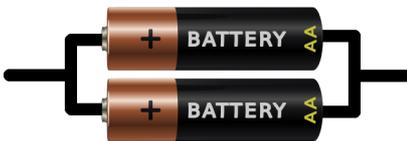
Disposer des accumulateurs en parallèle permet d'augmenter le courant et d'augmenter l'autonomie. La tension reste inchangée.
